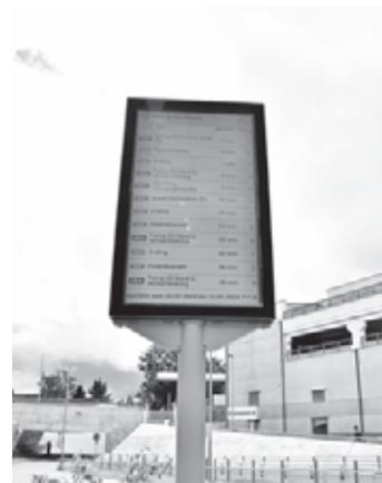
Die Gemeinde Poing hat in Zusammenarbeit mit dem MVV die erste digitale Fahrgastinformation (DFI) am Standort Poing (S) Nord eingerichtet. Hier werden aktuelle Ankunftszeiten sowohl des MVV-Busverkehrs als auch der S-Bahn angezeigt. Das Gerät ist auch mit einer Sprachausgabe ausgerüstet, so dass z. B. Sehbehinderte auf Druckanforderung die Fahrzeiten angesagt bekommen. Weitere Standorte im Gemeindegebiet werden derzeit geplant! (rei)
