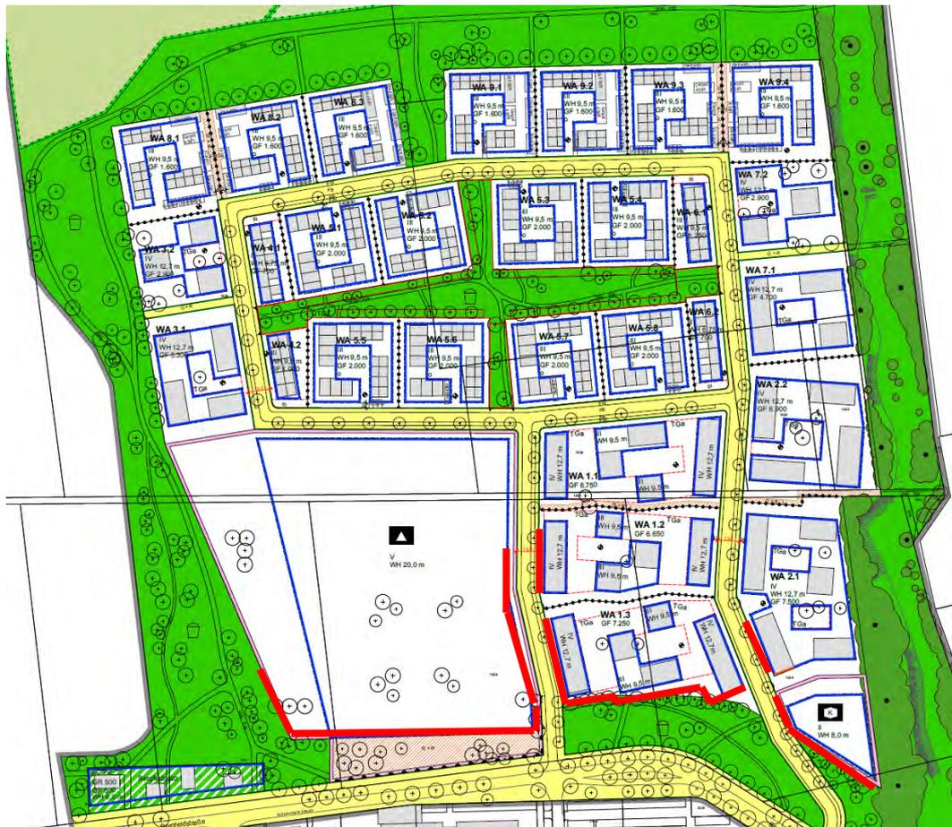
Abbildung 1. Fassadenkennzeichnung für maßgebliche Außenlärmpegel  $L_a \geq 61$  dB(A) nach DIN 4109-2 (rote Linie) für die Planvariante A (I-Erschließung).
